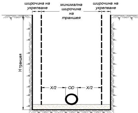
Фиг. 1. Укрепена траншея
