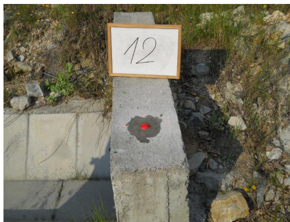
Фигура 6. Стабилизиране на гъбовиден болт в съоръжения
