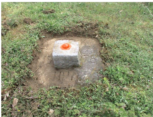
Бетониран каменен блок с гъбовиден болт (код 52)
