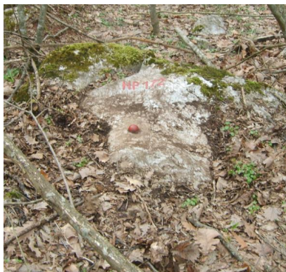
Фигура 9. Стабилизиране на гъбовиден болт в скала
