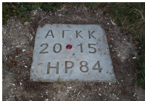
Фигура 8. Стабилизиран гъбовиден болт на терен
