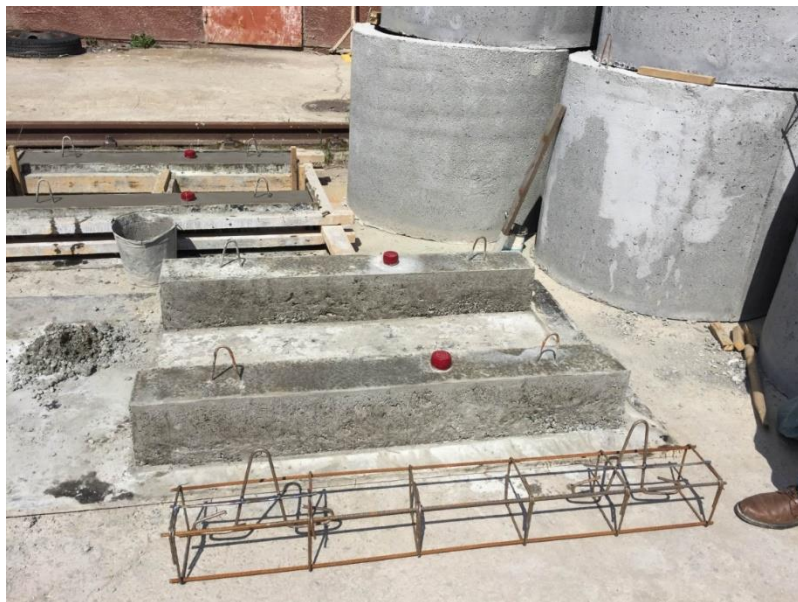
Фигура 3. Изработване на бетонов стълб на показалец към ВНР I и II степен
